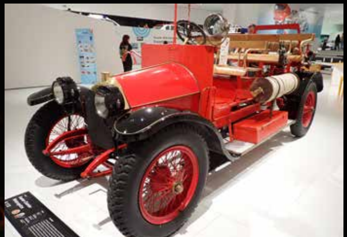
Austro Daimler Motorspritze, 1912, 4 Zylinder, 2010 cm 3 , 20 PS, 55 km/h
