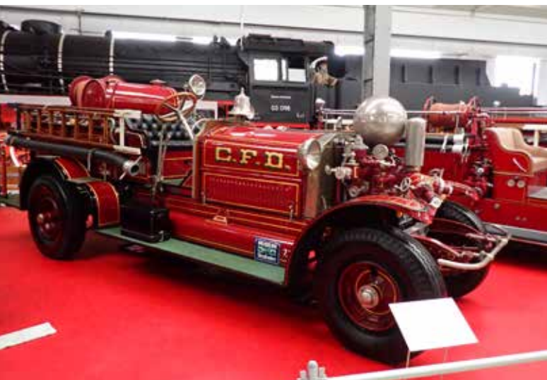
Ahrens-Fox MK 4, Baujahr 1916, 6 Zylinder, 12.000 ccm, 150 PS
