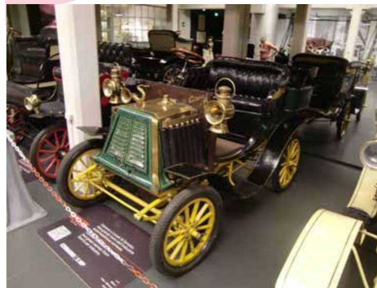
Ceirano 5 HP, Bj. 1901, 1 Zylinder, 639 ccm, 45 km/h
