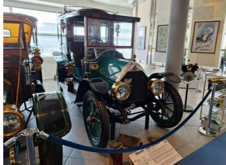
Bianchi Tipo C 20-30 HP, Bj. 1909, 4 Zylinder, 4396 ccm, 90 km/h
