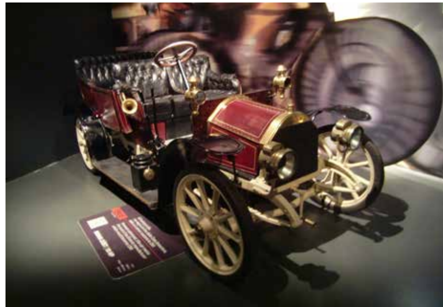
Brixia Züst 10 HP, Bj. 1909, 3 Zylinder, 1386 ccm, 55 km/h
